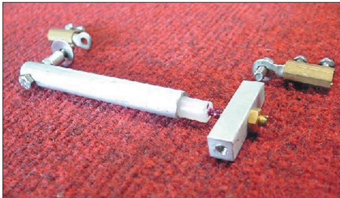
Les trappes doivent être parfaitement accordées sur les fréquences pour lesquelles elles sont réalisées. A cet effet, si vous êtes bricoleur avec un minimum d'outillage, à savoir une perceuse à colonne et une boîte de tarauds de 4 mm, vous pouvez réaliser des capacités réglables. Voir photos .
